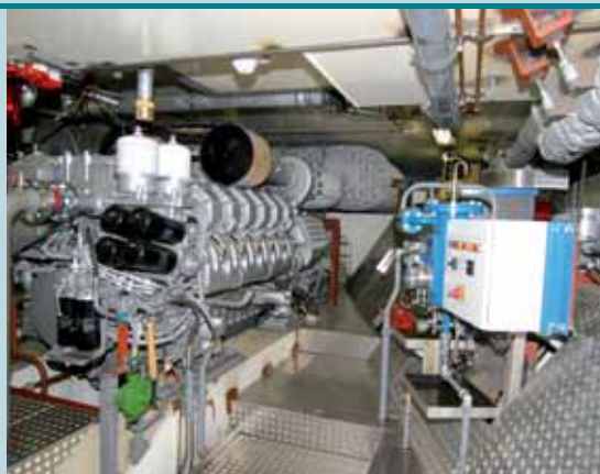
Die MTU-Hauptmaschine leistet 1.320 kW. Gelöscht wird in Bugmotoren- und Maschinenraum mit CO 2
