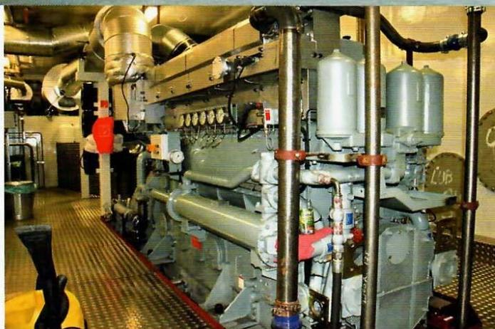
Einer der beiden Mitsubishi-Hauptmotoren vom Typ S6U-C2 MPTK, die jeweils eine Leistung von 1.007 kW bei 1.060/min an die Wärtsilä-Propeller abgeben
